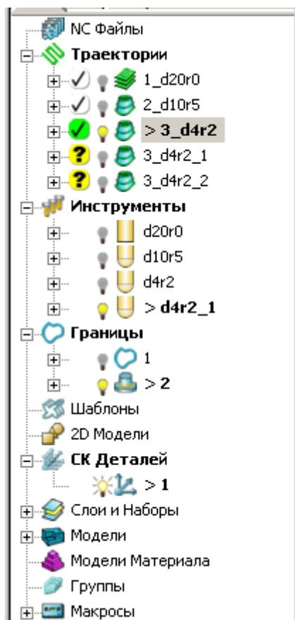
Мы решаем проточить фрезу до необходимой длины. Разделять программу на две части (с короткой и длинной фрезой) мы признаем нерациональным, поэтому я удаляю вторую и третью программы.
